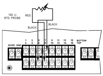
NOTE: PICTURE SHOWS CONNECTION FOR MODULE IN POSITION 1.
